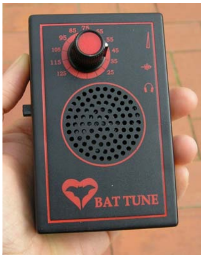
Foto 1.- Detector heterodí Bat Tune , versió 2.
